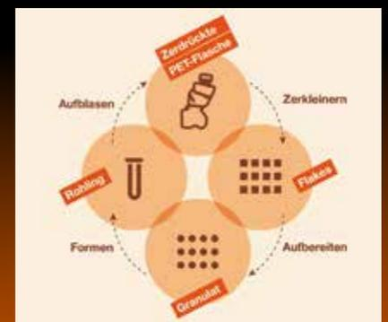
So funktioniert der Kreislauf: Die gesammelten PET-Flaschen werden beim PET Recycling Team gewaschen und zu Flakes zerkleinert. Daraus entsteht Granulat, aus dem ALPLA Rohlinge herstellt. Die werden beim Getränkehersteller aufgeblasen und wieder befüllt.
